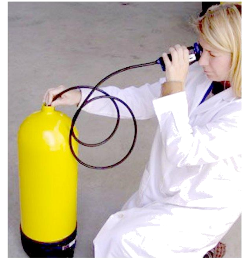
Inspección visual interna de un cilindro de buceo
