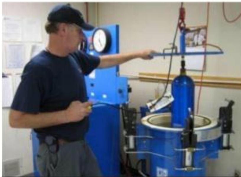
Prueba hidráulica de un cilindro de buceo en una prensa hidráulica
