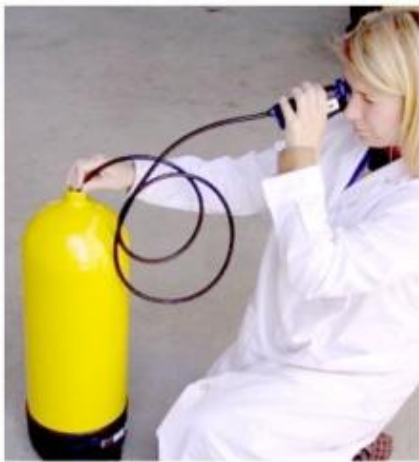
Inspección visual interna de un cilindro de buceo
