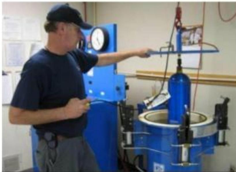
**Prueba hidráulica de un cilindro de buceo
